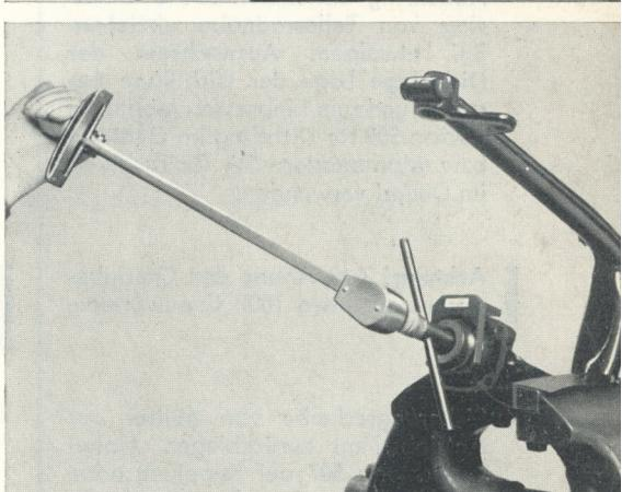
**¡Atención!** Comprobar antes del montaje, si el eje cardán tiene una ranura de chaveta y chaveta o si carece de éstas. Las campanas con ranura de chaveta sólo deben ser montadas con ejes de cardán provistos de ranura y chaveta.
