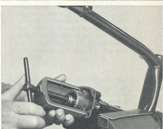
2. Sujetar la campana de cardán con el dispositivo de extracción 299a, colocar entre el husillo de este extractor y el eje cardán una pieza de prolongación adecuada y extraer de este modo la campana. Retirar la campana y el eje de cardán. **Fig. 148**
